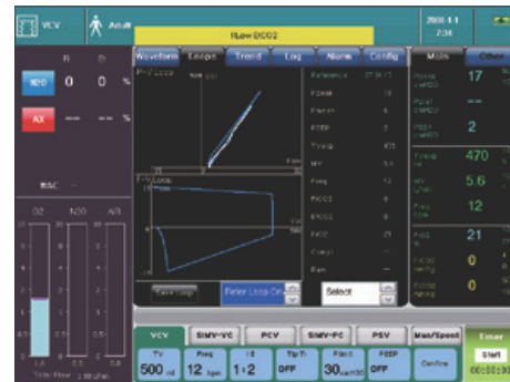
Измерение показателей давления воздуха, скорости потока, объема, состава и сопротивления на вдохе в реальном времени позволяет оперативно обнаружить утечку, обструкцию дыхательных путей и внести необходимые изменения в параметры
